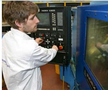
Spécialiste en usinage, il réalise des pièces techniques, sur des machines d'usinage à commande numérique. Il est particulièrement sensibilisé à l'activité aéronautique et spatiale caractérisée par :
